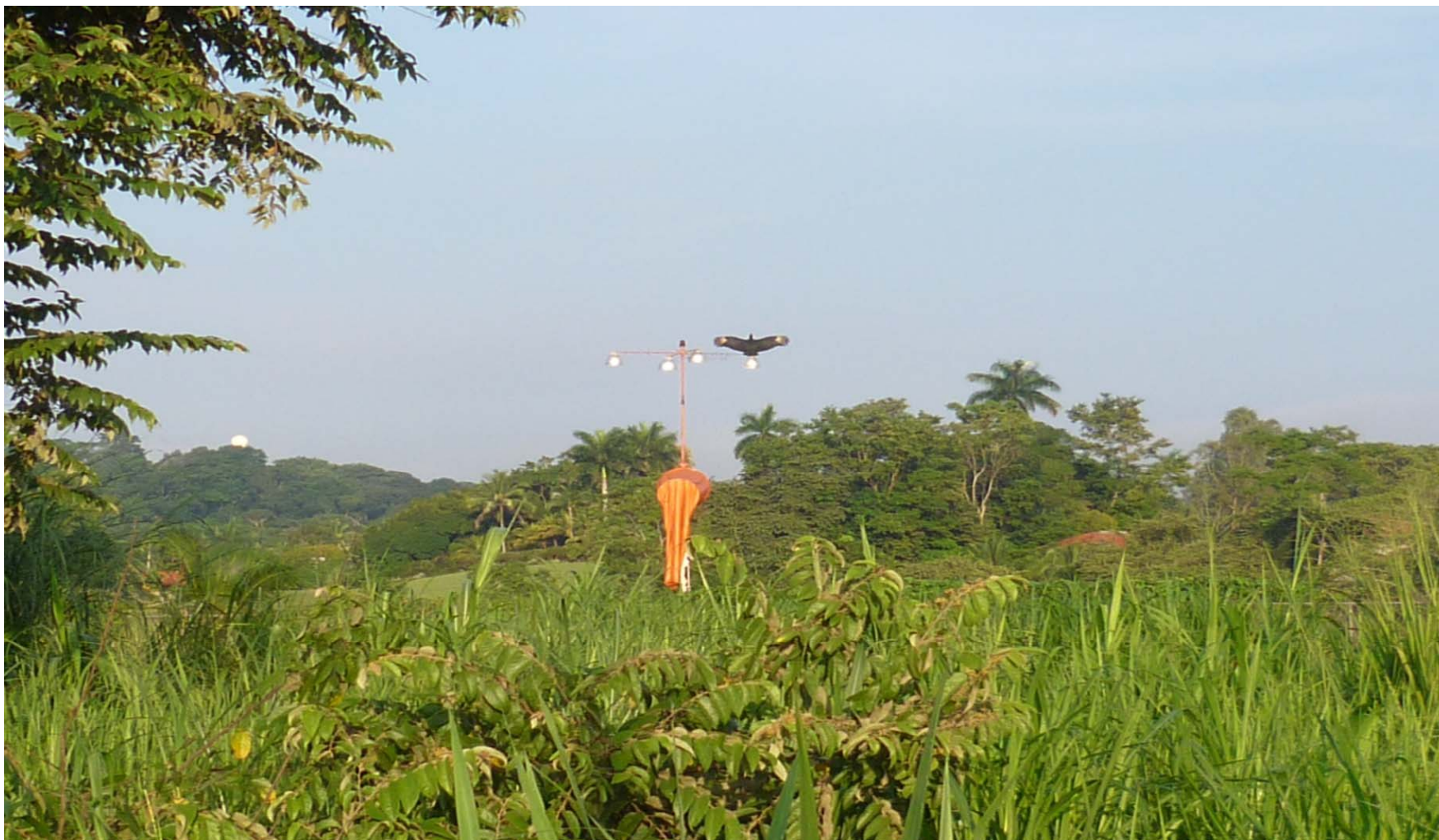
Mangas de vientos iluminada
